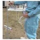
SWS 試験孔を利用してロープ式水位計を差し込む。水位センサー先端が20mm 水中に入ると電子音で知らせる
